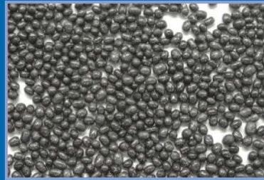
Runde Schaumperlen für Anwendungen in Strukturbauteilen
